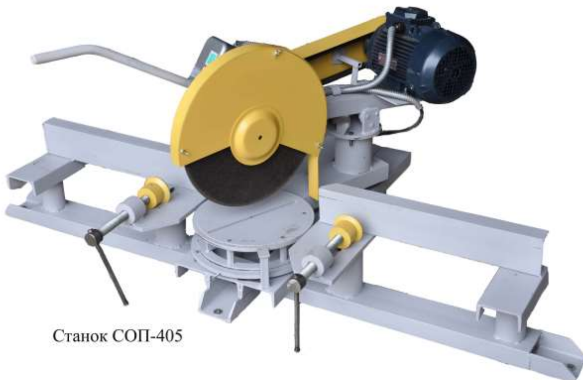
Станок СОП-405 (СО-400) с поворотной головкой 5,5кВт
